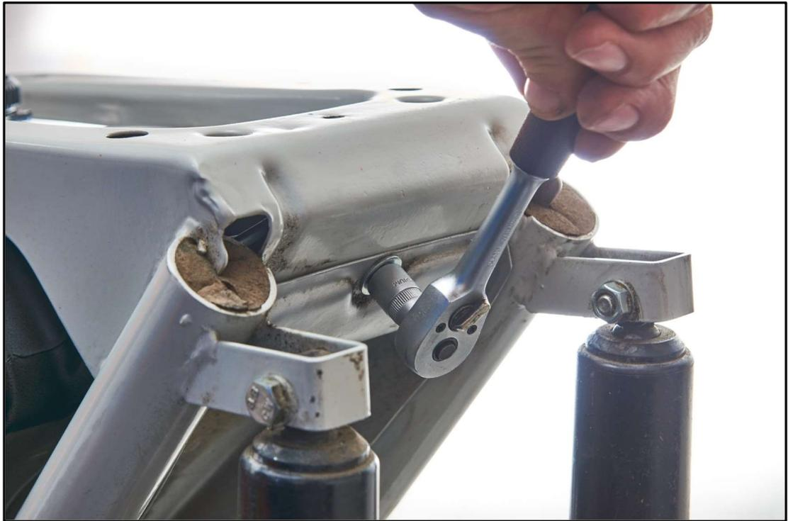
c.) Setzen Sie anschließend die beiden M6x20 Schrauben/U-Scheiben, sowie die Sicherungsmuttern M6/Scheiben an der Vorderseite des Adapterblechs an. Ziehen Sie diese vorerst auch nicht an. (Spalt ca. 0,5mm)
