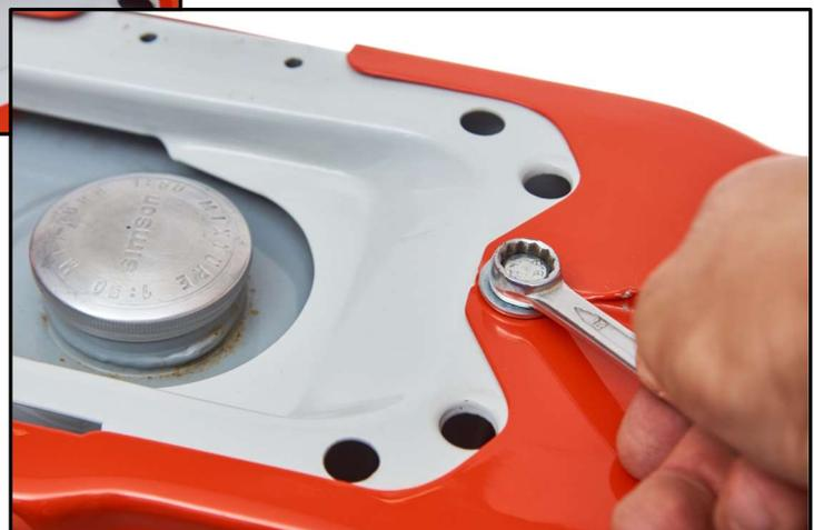
8. Entfernen Sie die 2 Stück M8 Schrauben der Fußrasten - (Werkzeug: Ratsche Stecknuss SW13)
