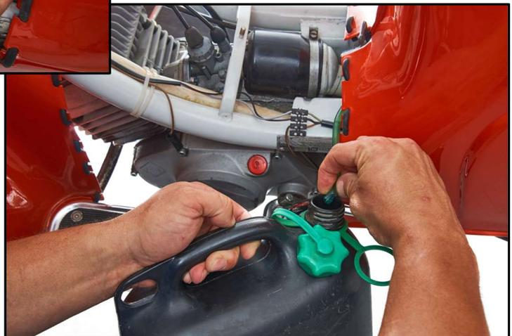
5. Öffnen Sie den Benzinahn auf Reservestellung, um restlichen Kraftstoff abzulassen. (Auf der Abbildung ist der Benzinahn in Reservestellung)
