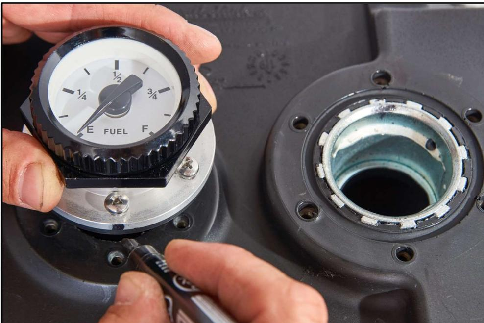
f.) Zum Verschrauben bitte die beigelegten M5 Linsenkopfschrauben verwenden und mit einem max. Anzugsmoment von 4Nm über Kreuz anziehen.
