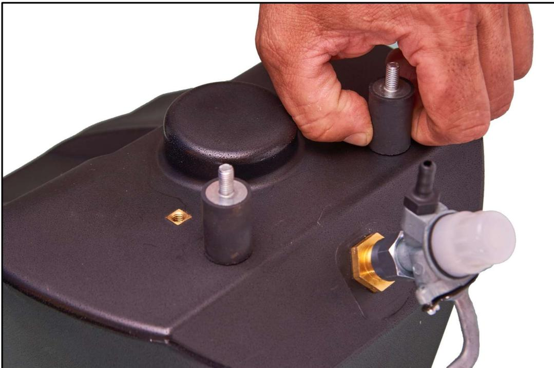
e.) Der einzelne Metallgummi auf der Rückseite mit einer M6 Sicherungsmutter plus Scheibe, ungefähr in der Mitte des Langlochs platzieren und ebenfalls mit 5Nm anziehen. (SW10 Maulschlüssel mit einstellbarem Anzugsmoment verwenden)
