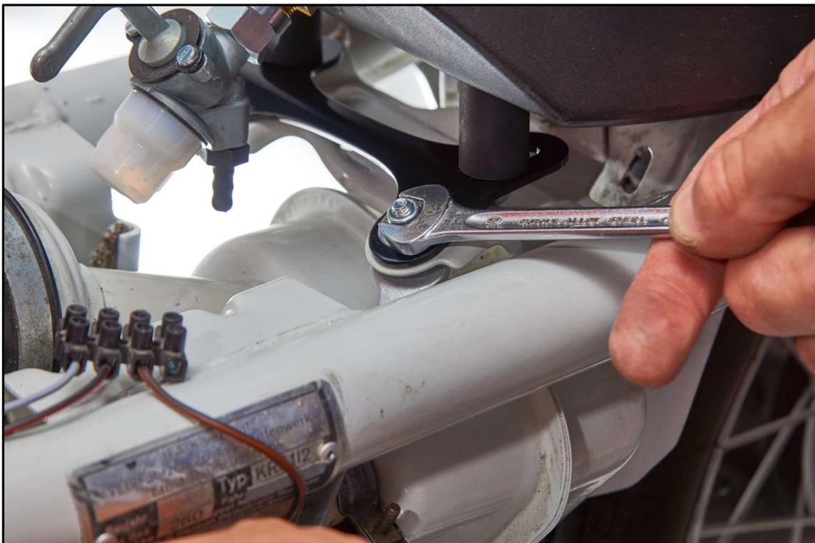
g.) Abschließend die M6 Sicherungsmuttern zwischen Adapterblech und Kraftstoffbehälter mit 6Nm angezogen. Wichtig: Die Schwingungsdämpfer dürfen nicht „verdreht werden“ und müssen deshalb bis zum Anliegen am Adapterblech von Hand oder mit einer Rohrzanze festgehalten werden. SW10 Maulschlüssel mit einstellbarem Anzugsmoment verwenden)
