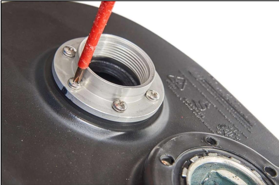
g.) Abschließend schrauben Sie die Tankanzeige über die Rändelung, oder an Ihrem Sechskant mit einem max. Anzugsmoment von 10Nm ein.
