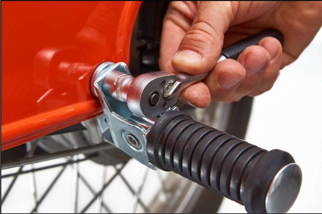
9. Entfernen Sie die 2 Stück M6 Schrauben (rechts und links) im vorderen Bereich der Heckverkleidung (Werkzeug: Ring/Gabelschlüssel SW10)
