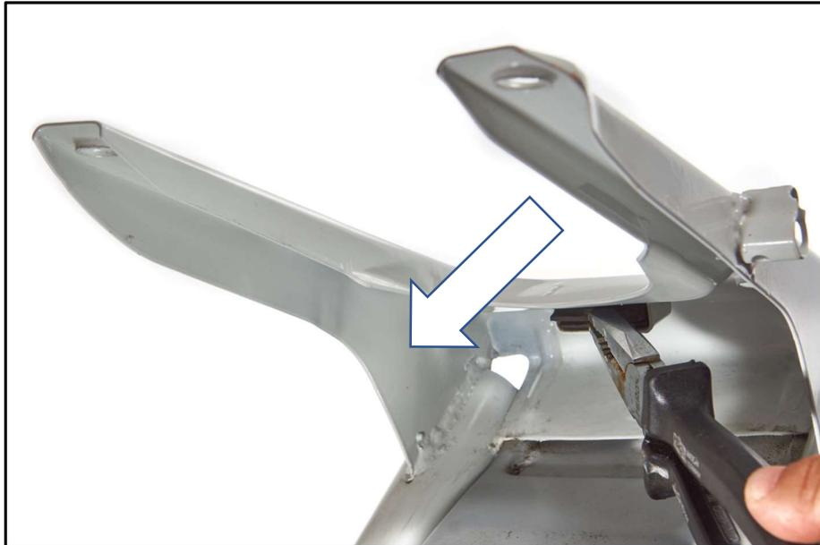
15. Ein Reinigen der Aufnahmepunkte wird dringend empfohlen. Auch ist es ratsam die Befestigungspunkte am Rahmen zu entrostern, ggf. zu Lackieren oder mit Hohlraumversiegelung zu behandeln, um diese langfristig gegen Korrosion zu schützen.
