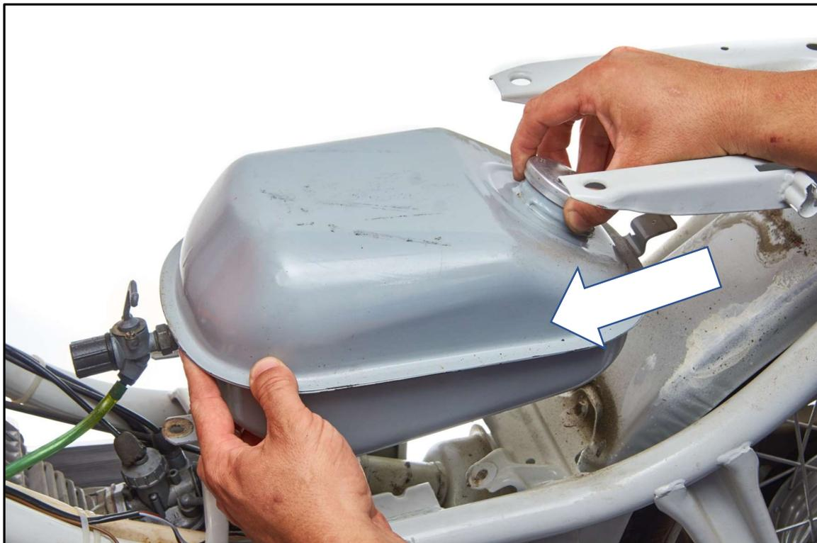
14. Nach der Entnahme des Behälters aus dem oberen Befestigungspunkt, entnehmen Sie das Elastomerteil aus dem oberen Aufnahmepunkt. (soweit noch vorhanden)
